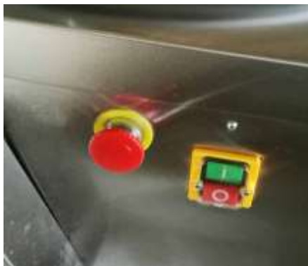
Рис.2 – Кнопка «АВАРИЙНЫЙ СТОП».
